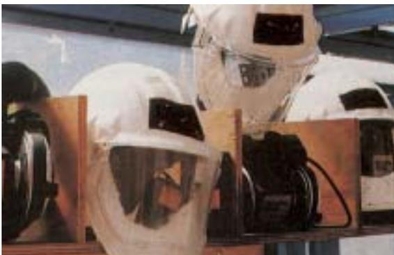
*Caschi integrali turboventilati*
