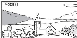
Nel modo 1 (ampio), il monitor visualizza un'immagine normale allungata uniformemente in senso orizzontale in modo da riempire un monitor wide-screen.
