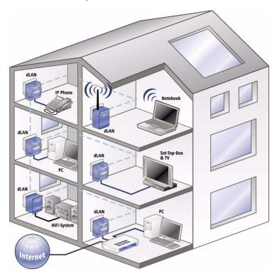
Con gli adattatori dLAN si possono comodamente trasferire non solo segnali di rete attraverso la normale rete elettrica, ma anche segnali audio in qualità CD, da computer dotati di connessione dLAN, ad apparecchiature di riproduzione idonee via Powerline. In questo modo è possibile rendere il suo computer una stazione trasmittente privata e ascoltare la musica preferita ovunque sia disponibile una presa elettrica!
