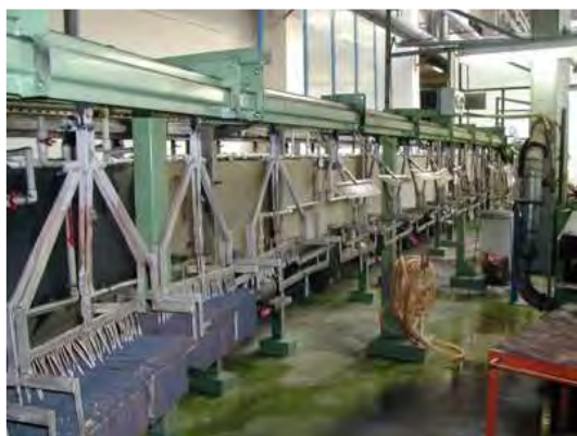
Fig. 3-27 Esempio di trasportatori a sospensione: in entrambi i casi la linea può trasportare pesi superiori ad 80 kg.
