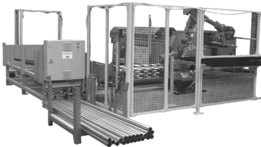
Fig. 4-18 Cella robotizzata per la formatura di tubi; fonte – Mewag Innovation
