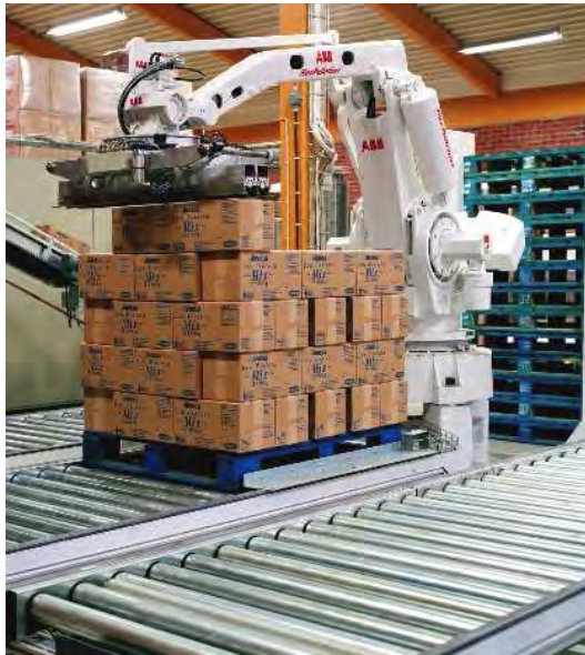
Fig. 3-29 Rulli trasportatori in esercizio in una RW – manipolazione ed impilamento di scatole di cartone
