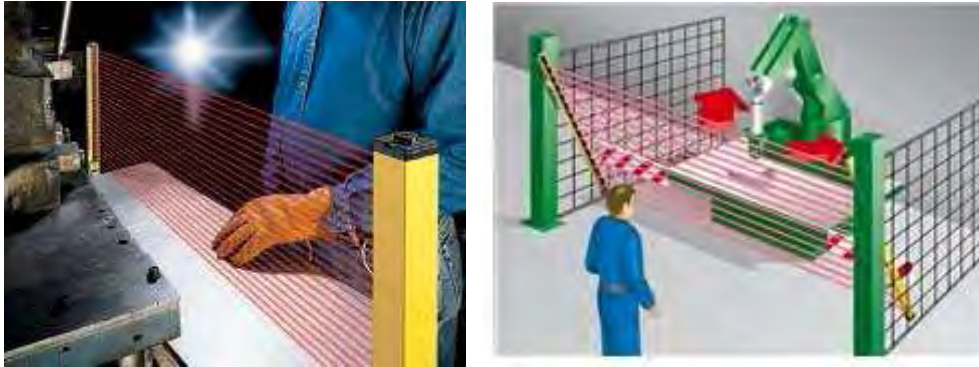
Fig. 6-11 Esempio di barriere fotoelettriche di sicurezza in uso
