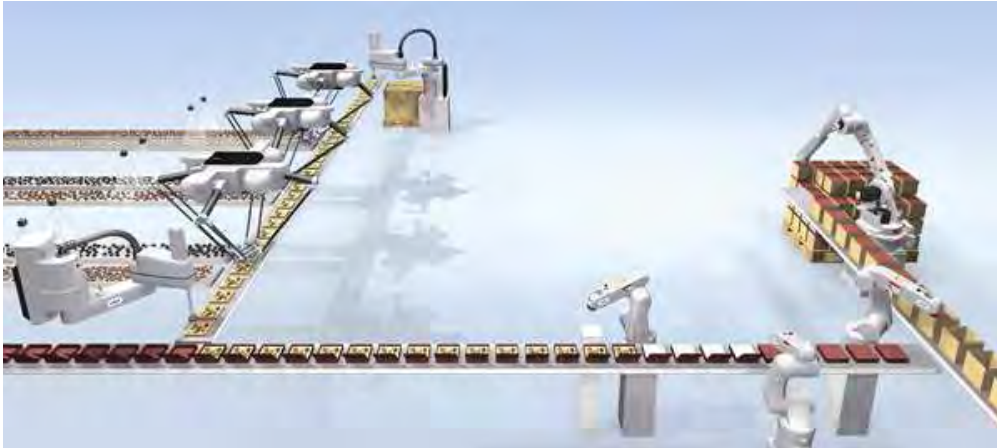
Fig. 3-35 Interconnessione di celle di lavoro robotizzate per mezzo di nastri trasportatori. Descrizione del layout interno della postazione di lavoro tecnologica robotizzata (RTW) in figura: Ci sono tre tipi di IR - strutture a catena cinematica seriale di tipo RRR e SCARA e strutture parallele di tipo TRIPOD. Compito del robot è di effettuare la manipolazione e l'assemblaggio di componenti piccoli e leggeri, ai quali ben si adatta questo tipo di PD. I trasportatori connettono le singole stazioni di lavoro con la postazione di assemblaggio.
