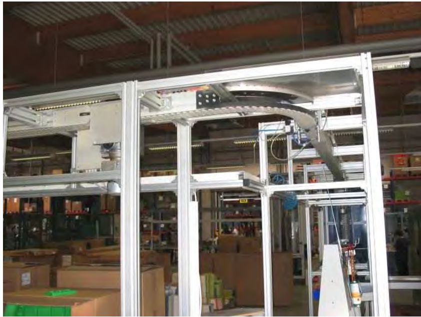
Fig. 3-24 Trasportatore a catena – telaio in lega di alluminio, curve ad inserto, forze elevate, materiali della catena: plastica o acciaio
