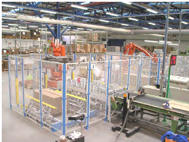
Fig. 3-21 Esempio di nastro trasportatore che fornisce componenti ad un robot manipolatore
