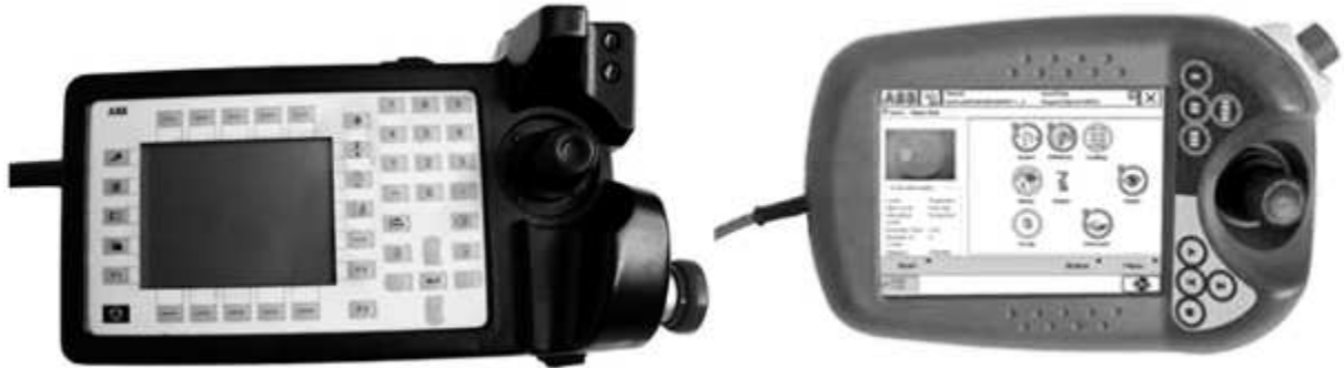
Fig. 5-3 Esempi di teach pendant a configurazione orizzontale ABB (dalla sinistra: un vecchio modello di teach pendant per il sistema di controllo S4CPlus; un teach pendant di nuova generazione per ABB IRC5 – (il così detto flex pendant).
