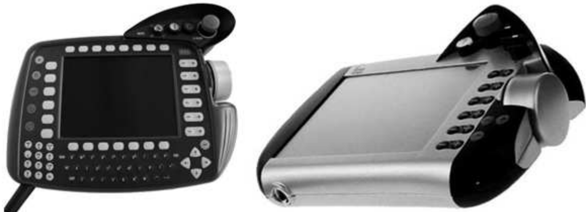
Fig. 5-4 Esempi di teach pendant KUKA (dalla sinistra: la tipologia attuale; prototipo di un teach pendant wireless con touch screen ed interfaccia vocale)
