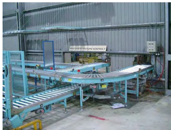
Fig. 3-30 Rulli trasportatori interoperazionali durante la produzione di dischi in lega leggera per automobili
