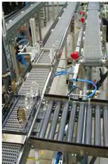
Fig. 3-23 Linea di produzione per occhiali – trasportatori modulari
