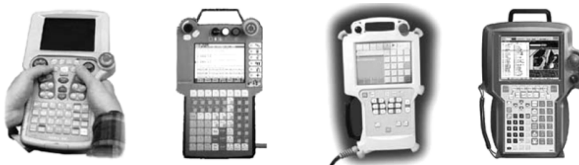
Fig. 5-2 Esempi di teach pendant a configurazione verticale (dalla destra: Motoman; Reis; Kawasaki; Fanuc)
