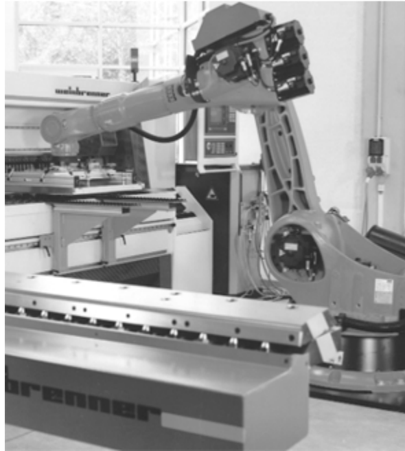
Fig. 4-17 Robot industriale KUKA usato come manipolatore ausiliario al momento della piegatura di componenti in lamiera; fonte - KUKA Industrial Robot
