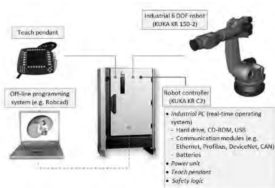
Fig. 5-1 Componenti fondamentali di un sistema robotico industriale
