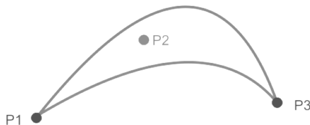
Fig. 5-13 Moto generico (PTP, MoveJ); il punto P2 è approssimato.
