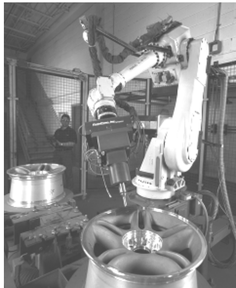
Fig. 4-20 Rettifica di un cerchione; fonte – PushCorp, Inc.
