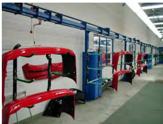
Fig. 3-27 Esempio di trasportatori a sospensione: in entrambi i casi la linea può trasportare pesi superiori ad 80 kg.
