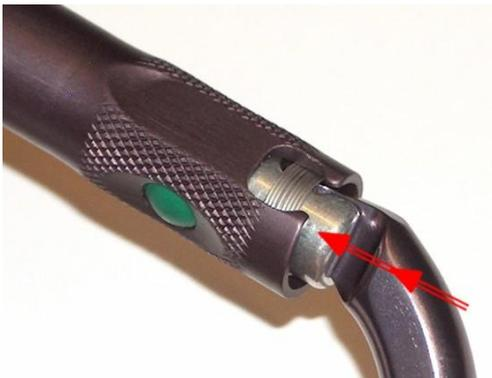
Spingere il fermo elastico completamente nell'apertura
