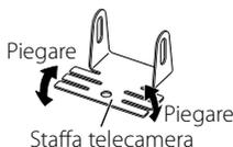
Adattare la forma della staffa della telecamera in modo che sia adatta per la posizione di installazione della telecamera.
