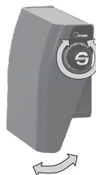
Il dispositivo di comando a ginocchio dispone di una manopola di regolazione mediante la quale è possibile impostare il numero massimo di rotazioni. Impostare la manopola sul numero di rotazioni desiderato; azionando il dispositivo di avvio a ginocchio è possibile regolare il numero di rotazioni sul valore predefinito.
