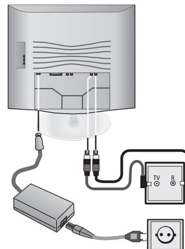
Posare i cavi verso il basso. Aprire il serracavo nella parte inferiore e inserire i cavi nel serracavo. Una volta posati tutti i cavi, richiudere il serracavo.
