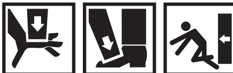
**Schiacciamento degli arti o del corpo a causa di errate movimentazioni del carico.**
