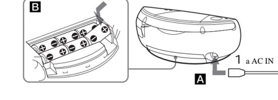
Collegare il cavo di alimentazione **A** o inserire sei pile R20 (formato D) (non in dotazione) nello scomparto pile **B**.
