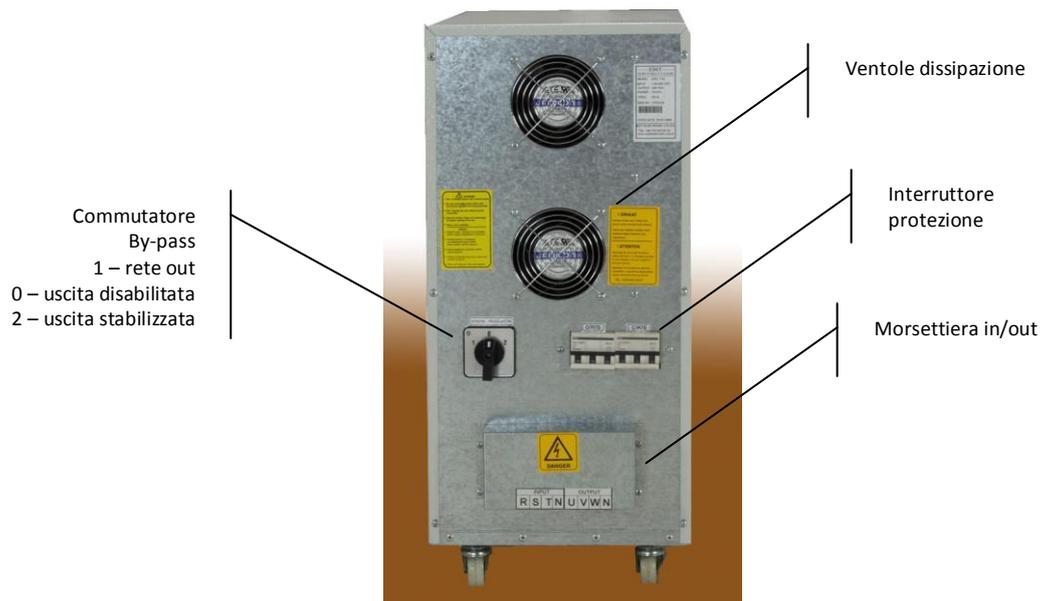
Se i collegamenti sono corretti si può spostare il commutatore di by-pass in posizione "2" (stabilizzatore) e sollevare l'interruttore di ingresso.
