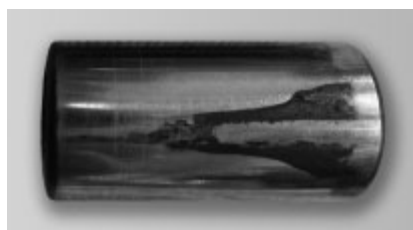
Corrosione da inattività sui rulli
