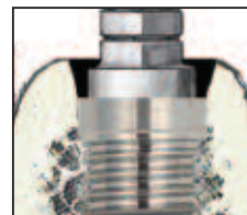
Impianto posizionato troppo in profondità
