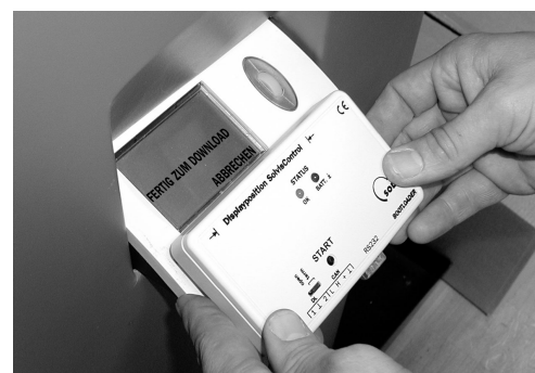
Fig. 9: Trasferimento dei dati con l'interfaccia ad infrarossi
