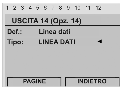
Fig. 12: Modificare l'uscita 14 della SolvisControl su "Linea dati"
