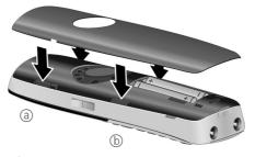
▶ Posizionare il coperchio batterie inserendo prima gli agganci della parte superiore ⓐ e poi quelli della parte inferiore ⓑ premendo sul coperchio fino al completo innesto.
