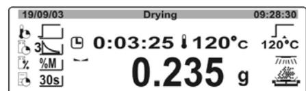
Con il tasto **M** la visualizzazione può essere commutata nelle diverse unità del risultato di misurazione.
