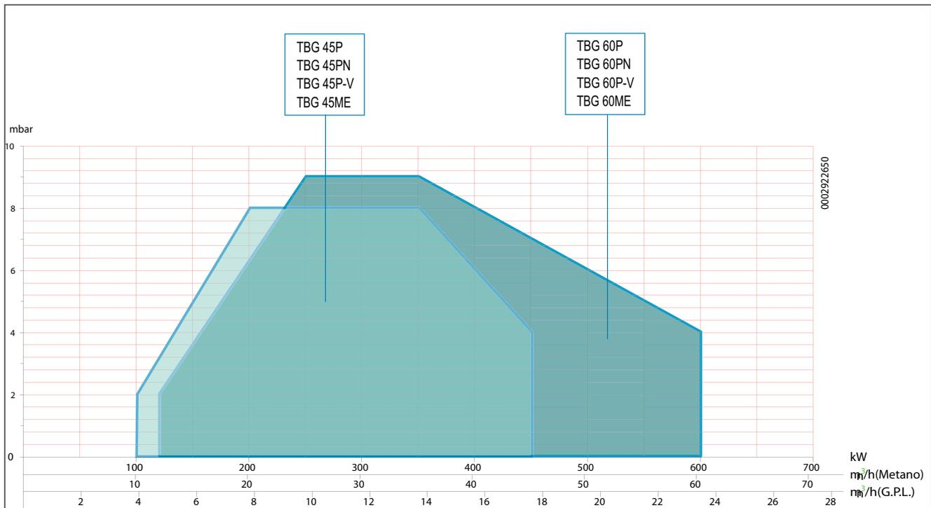
I campi di lavoro sono ottenuti su caldaie di prova rispondenti alla norma EN676 e sono orientativi per gli accoppiamenti bruciatore-caldaia. Per il corretto funzionamento del bruciatore le dimensioni della camera di combustione devono essere rispondenti alla normativa vigente; in caso contrario vanno consultati i costruttori.
