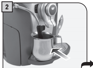
2 Einen Behälter unter das Dampfrohr stellen.
