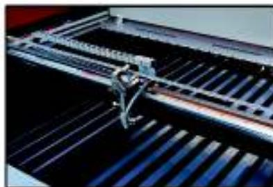
Percorso del raggio facilmente regolabile e plottato con guide micrometriche
