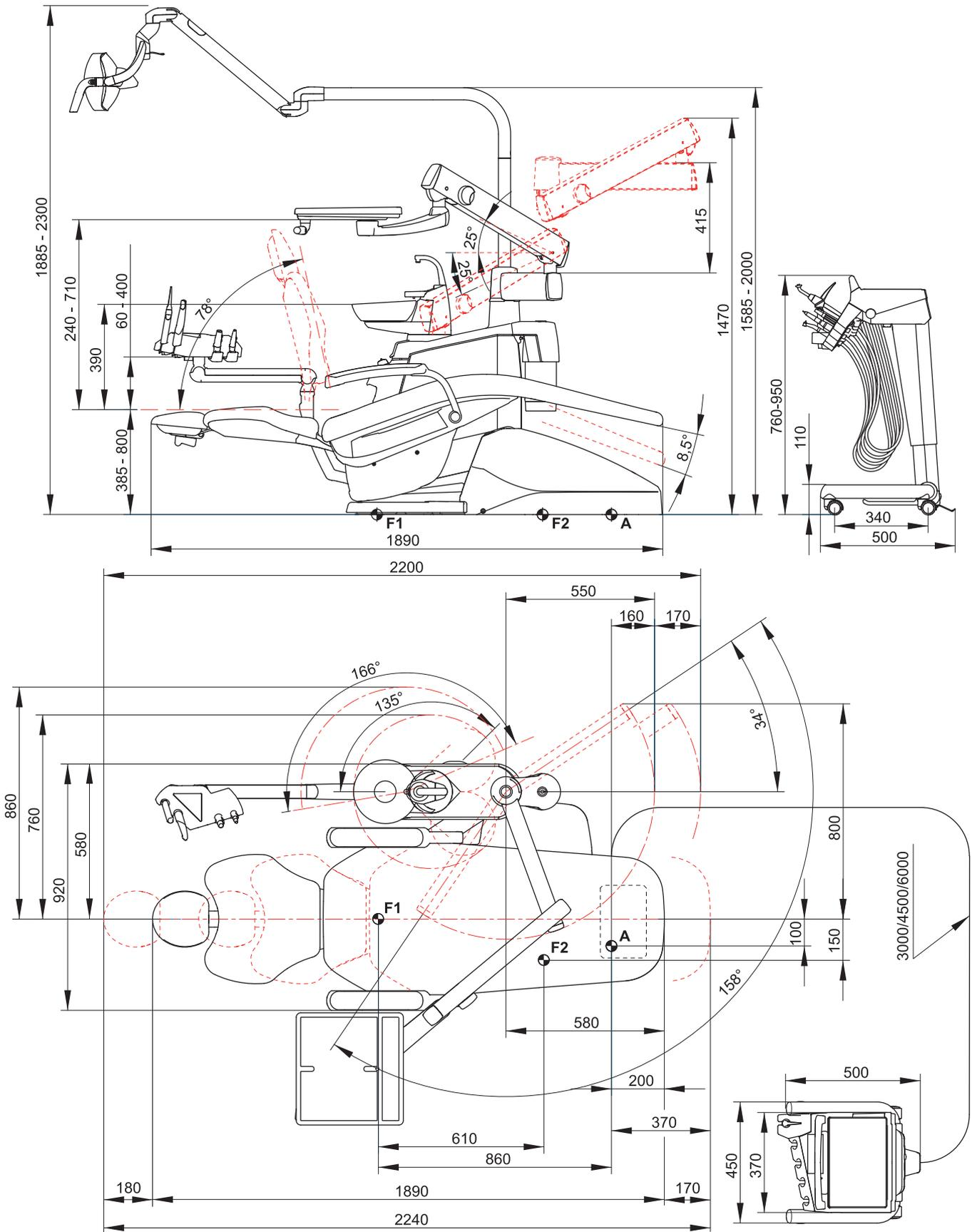
11.5. Caratteristiche dimensionali modello A5 SINGLE CART
