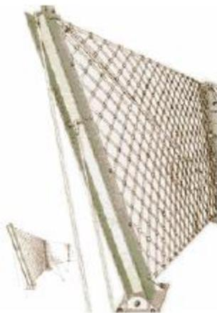
Si tratta di un intervento atto a creare una valida protezione passiva contro la caduta di pietre ed è costituito da elementi deformabili ad elevato assorbimento energetico; strutture prodotte in regime di qualità UNI-EN-ISO9001:2000, atte alla protezione da fenomeni di caduta massi con sviluppo energetico da 250 a 2.000 kJ.
