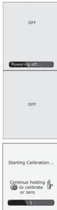
3. Il rilevatore entra in modalità di azzeramento. Mentre lo strumento azzerava tutti i sensori, sul display viene visualizzato **zeroing** (azzeramento in corso).
