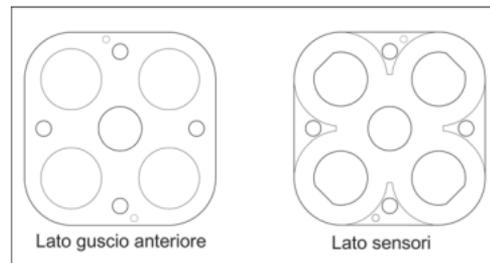
5. Prima di riassemblare il rilevatore, controllare che le superfici di tenuta sui gusci anteriore e posteriore siano pulite e prive di umidità.
