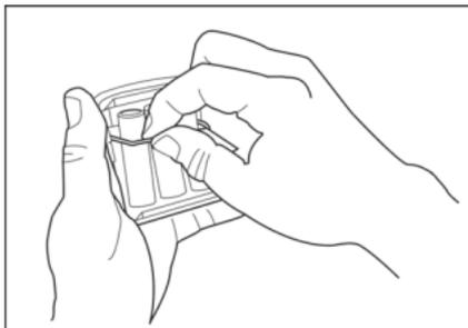
6. Togliere le batterie. Riportare la barra di espulsione nella posizione originaria, in piano. Controllare che la barra di espulsione agganci il fermaglio di rilascio.
