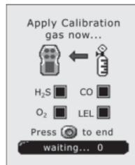
6. Il rilevatore inizia a tarare i sensori. Durante lo span si verifica quanto segue:
