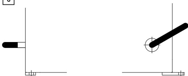
Consente il rilascio del fissaggio della ruota sulla flangia. **Non azionare durante il ciclo della macchina e/o quando vengano montate flange differenti da quella a cono standard.**
