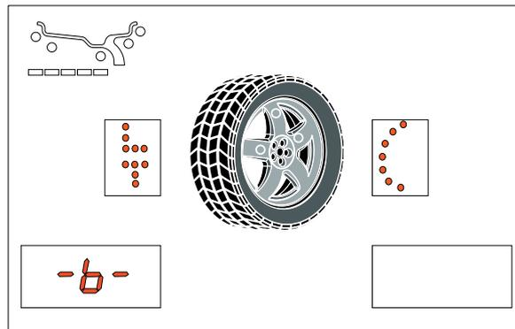
La scritta LT sul display a matrice sinistro indica che è inserita la misura delle ruote tipo LIGHT TRUCK (ruote di grosse dimensioni quali fuoristrada, autocarri o ruote molto sporgenti dal cerchione).
