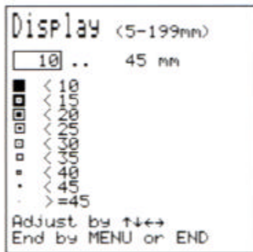
Fig. 5.12 Regolazione della gamma della scala di grigi
