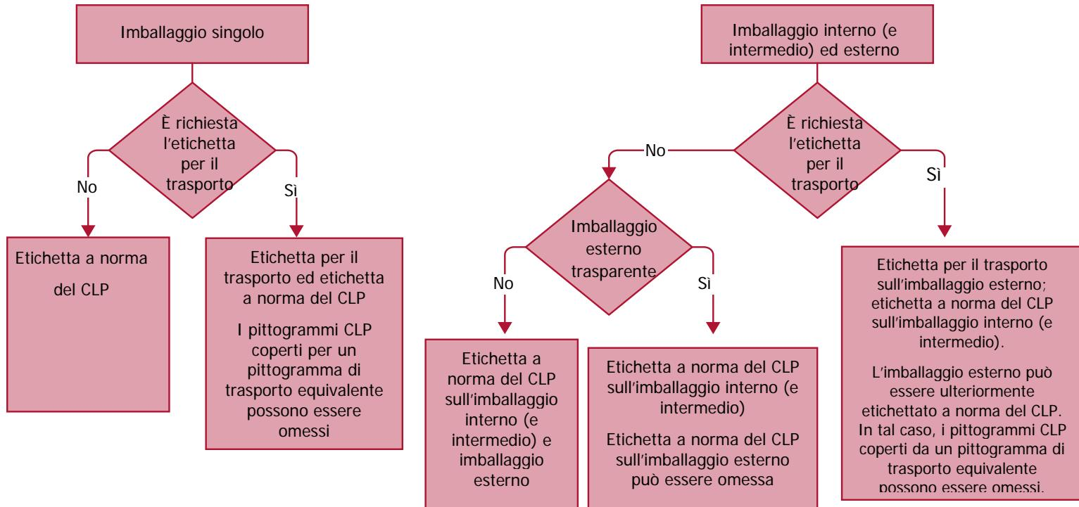
**Figura 3:** Diagramma di flusso decisionale per l'applicazione dell'etichettatura di trasporto e quella a norma del CLP per imballaggi singoli (a sinistra) e imballaggi combinati (a destra)
