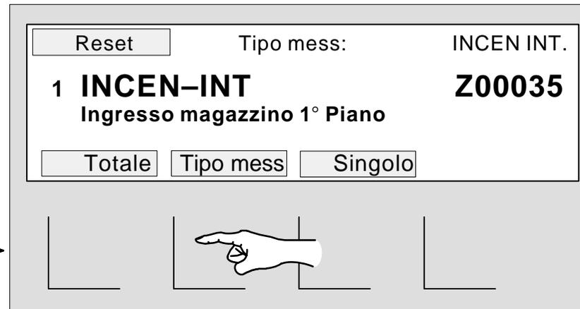
⇒ Premere il tasto multifunzione "Tipo mess" per resettare tutti i sensori di tutte le zone con **tipo di messaggio** (p. es. INCENDIO interno) selezionato.
