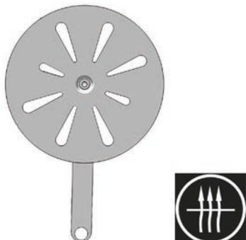
La griglia smuovicenere dovrebbe rimanere sempre aperta durante il funzionamento. La regolazione dell'aria di combustione si effettua tramite la leva di regolazione aria.
