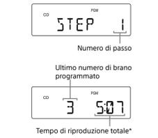
\* Appare "----" quando si programma un disco MP3/WMA/dispositivo USB o quando il tempo di riproduzione totale è maggiore di 100 minuti.
