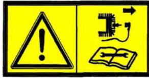
Scollegare il cavo candela prima di ogni operazione di manutenzione
