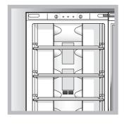
Il sistema No Frost consente, grazie alla presenza di numerose celle d'aerazione, di ottenere una circolazione costante dell'aria e rendere uniforme la temperatura presente all'interno del frigorifero mediante un'omogenea ventilazione del vano. Il No Frost gestisce un
