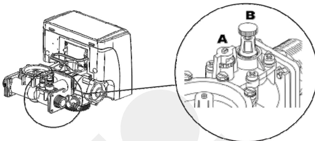
Per la regolazione della valvola miscelatrice, sono presenti due viti, una per la regolazione grossolana (posizione B) e l'altra per la regolazione fine (posizione A).
