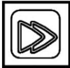
In modalità PROGRAMMAZIONE questo tasto serve per incrementare il valore del digit selezionato. Ad ogni pressione si avrà l'avanzamento di una cifra. Se si tiene premuto si avrà l'avanzamento veloce.
