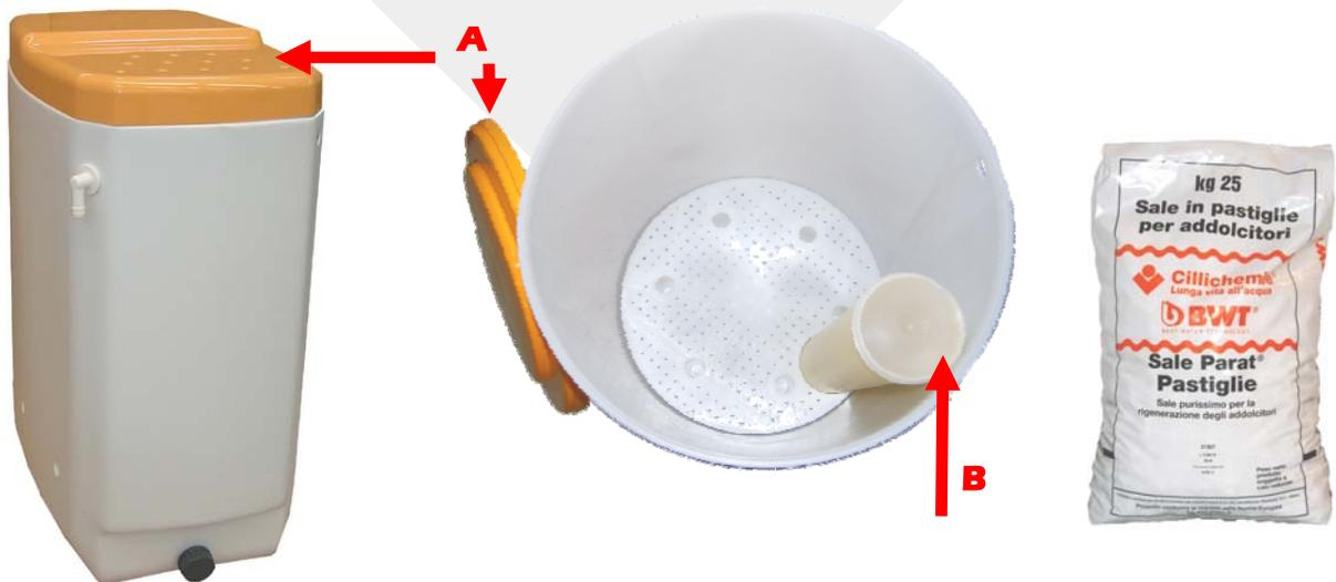
I modelli 58-78-118 sono dotati di serbatoio a base rettangolare mentre i modelli 168-228 hanno il serbatoio cilindrico. Sollevare il coperchio **A**. Inserire il sale nel serbatoio facendo attenzione che il tappo **B** a protezione della valvola salamoia sia correttamente posizionato. Al termine riposizionare il coperchio **A**.
