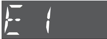
Fig. 7-1 Esempio visualizzazione di un errore "E 1" - Primo errore
