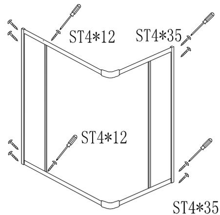
4. Installare la struttura a vetri sulla base, usare viti per fissare il pannello posteriore e la struttura di vetro.
