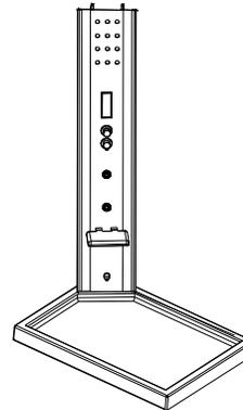
**Fase 4: Collegamento dei pannelli posteriori e della base.** Mettere il pannello posteriore sulla vasca, poi usare le viti M6x25 per fissarli seguendo i fori. In caso i fori non coincidano praticarne di nuovi o allargare i presenti.
