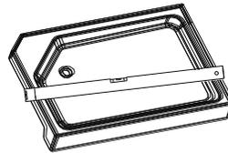
**Fase 3: Installazione del pannello posteriore.** Usare le viti M6x25 per collegare il pannello con la base
