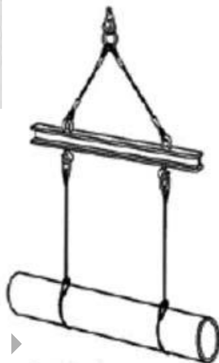
Imbraco con bilanciere per carichi lunghi
