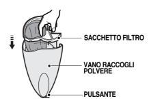
Reinserire con cura il sacchetto filtro nel vano raccogli polvere. Verificare che sia in posizione corretta e installato stabilmente nelle scanalature.
