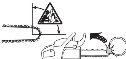
Il contraccolpo avviene sempre lungo il piano di taglio della lama. Di solito il movimento di motosega e lama è verso l'alto e verso l'operatore. Possono tuttavia verificarsi altre situazioni a seconda della posizione della
