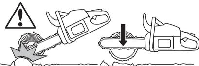
Se è possibile (si può girare il tronco?) terminare a 2/3 dello spessore del tronco.
