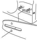
Tendere la catena con la vite apposita e la chiave combinata avvitandola in senso orario. La tensione è corretta quando la catena rimane nella scanalatura intorno alla lama. Vedere le istruzioni alla sezione Tensionamento della catena.
