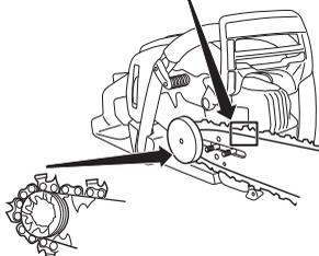
Controllare che il taglio dei denti sia rivolto in avanti, sul lato superiore della lama.
