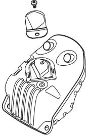
La marmitta è dimensionata in modo da diminuire la rumorosità e per allontanare i gas di scarico dall'operatore. I gas di scarico sono caldi e possono contenere scintille, pericolose in presenza di materiale infiammabile.
