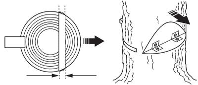
Se il fulcro è insufficiente, se è stato segato completamente o se il taglio direzionale è male eseguito, non è possibile controllare la caduta dell'albero.
