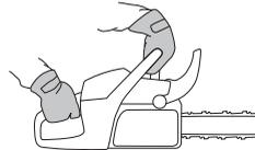
Accelerare al massimo e attivare il freno della catena girando il polso sinistro verso la protezione anticontroccolpo. Non lasciare l'impugnatura anteriore.
