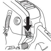
NB! Il contatto di avviamento/arresto torna automaticamente in posizione di marcia. Prevenire l'avviamento involontario staccando sempre il cappuccio dalla candela prima di effettuare operazioni di montaggio, controllo e/o manutenzione.
