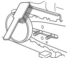
Controllare con regolarità che la fascia frenante abbia almeno uno spessore di 0,6 mm nel punto di maggiore usura.
