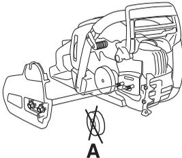
Montare la lama sui perni di fissaggio. Spingere la lama indietro al massimo. Sistemare la catena sopra la ruota motrice e farla passare nella scanalatura. Cominciare dalla parte superiore.
