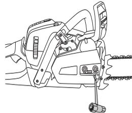
La tensione è corretta quando la catena rimane nella scanalatura intorno alla lama ed è possibile farla scorrere con le dita, senza sforzo. Serrare a fondo i dadi con la chiave combinata tenendo sollevata la punta della lama.
