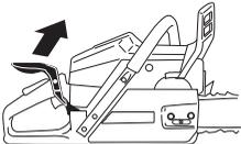
Spingere in avanti/verso l'alto la protezione anticontroccolpo per controllare che l'operazione possa venir eseguita facilmente e che sia stabilmente ancorata all'apposita guida nel coperchio della frizione.
