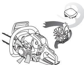
**IMPORTANTE!** Per mantenere sempre un livello ottimale di funzionamento della depurazione centrifuga, il sistema va pulito agli intervalli indicati. Pulire la presa dell'aria sul
