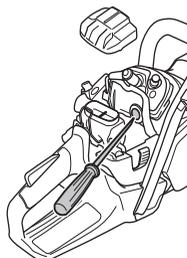
Per temperature inferiori ai -5°C e/o in presenza di neve, è disponibile una speciale copertura montata sul carter avviamento.
