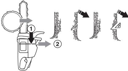
La profondità del taglio direzionale deve essere di 1/4 del diametro del tronco, con un angolo tra il taglio superiore e quello inferiore di almeno 45°.
