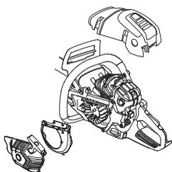
Pulire il sistema di raffreddamento con una spazzola una volta la settimana, più spesso se necessario. Se il sistema di raffreddamento è sporco o ostruito provoca il surriscaldamento della macchina, con conseguenti danni a cilindro e pistone.
