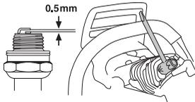
Osservare! Usare candele originali o di tipo raccomandato! Altre candele possono danneggiare cilindro e pistone. Controllare che la candela sia munita di dispositivo di soppressione interferenze radio.
