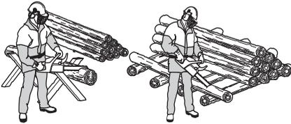
**Il tronco è per terra.** Nessun rischio di bloccaggio della catena o di rottura del tronco. Esiste il rischio che la catena vada a colpire il terreno alla conclusione del taglio.
