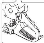
Dato che il freno della catena è ancora inserito il regime del motore deve scendere al minimo il più presto possibile, il che si ottiene disattivando velocemente il fermo del gas. In questo modo si evita di usurare
