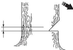
Inserire l'appoggio per la corteccia dietro il fulcro (se è stato montato l'apposito dispositivo). Lavorare a pieno gas e far avanzare la catena/lama lentamente nel tronco. Controllare che l'albero non si muova in direzione opposta a quella prevista per la caduta. Inserire un cuneo di abbattimento o un grimaldello non appena possibile.
