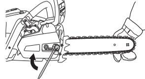
Controllare spesso la tensione di una nuova catena fino al termine del rodaggio. Eseguire il controllo regolarmente. Una catena correttamente tesa significa migliori caratteristiche di taglio e lunga durata.
