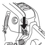
Il motore si ferma premendo il comando di avviamento/arresto.
