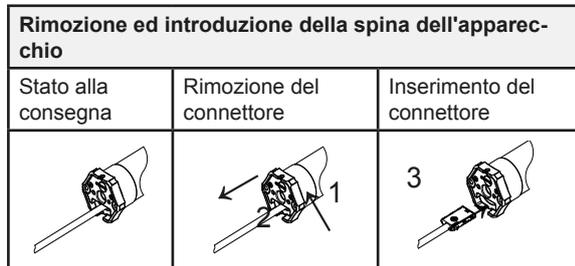
Fig. 4 Rimozione ed introduzione della spina dell'apparecchio
