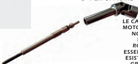
LE CANDELETTE MONTATE SU QUESTI MOTORI SONO MOLTO DELICATE E SE NON SI ADOTTANO LE DOVUTE PRECAUZIONI SI RISCHIA DI ROMPERLE NELLA SEDE E NON ESSENDOCI SPAZIO OPERATIVO NON ESISTE AD OGGI UN ESTRATTORE IN GRADO DI ESTRARLE IN CASO DI ROTTURA .
