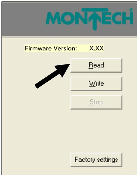
Cliccare su "Read" e controllare se il controller del motore ha memorizzato correttamente la configurazione.
