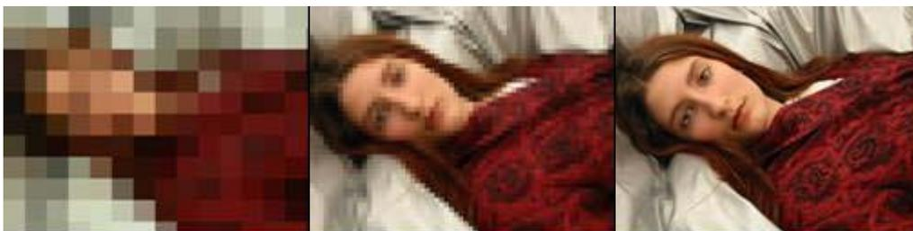
**Immagine 28** Un CCD con molti fotodiodi produce un’immagine più pregiata, con più dettagli. Una immagine catturata da un sensore con pochi pixel è per forza approssimativa, perché ciascun elemento di base scarica nel segnale la media delle cariche generate dalla parte di immagine che colpisce la sua superficie.
