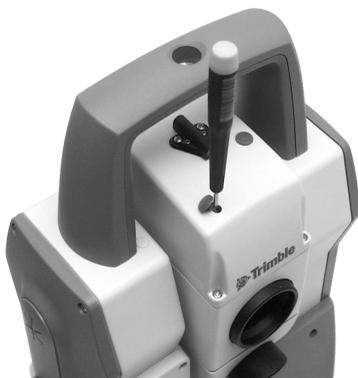
Per correggere orizzontalmente la posizione del punto laser, inserire la chiave a brugola nella porta di regolazione orizzontale e girarla.
