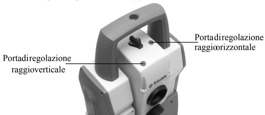
Per correggere la posizione verticale del punto laser, inserire la chiave a brugola nella porta di regolazione verticale e girarla.
