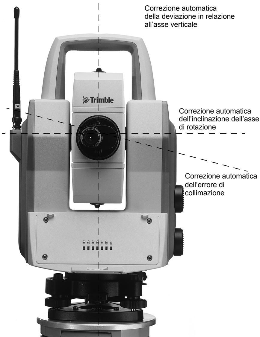
Figura 3.1 Il sistema di misurazione angoli
