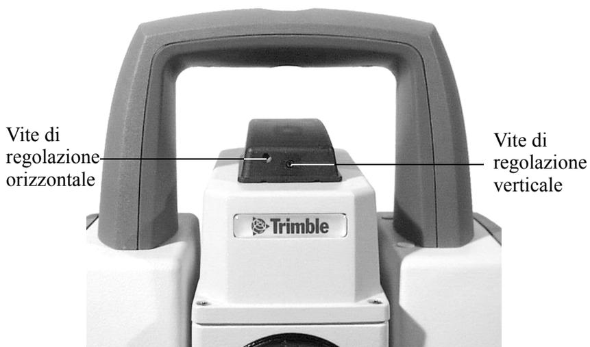
Figura 8.2 Viti di regolazione del puntatore laser
