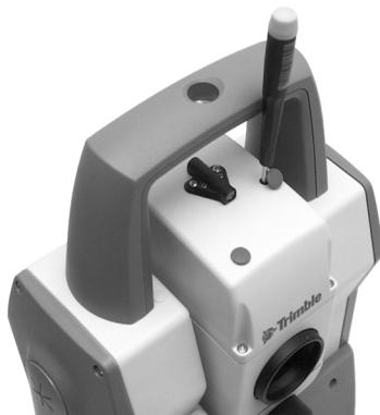
Infine controllare che il punto laser e il reticolo di mira coincidano. Durante tutta la procedura di regolazione mantenere il cannocchiale puntato verso il bersaglio. Le viti di regolazione sono ad alta tensione perché sono auto-bloccanti. Si serrano automaticamente dopo la regolazione.
