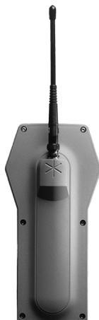
Il coperchio dell'unità radio è necessario quando si desidera usare lo strumento per il rilevamento remoto o il rilevamento robotico (stazione totale ad operatore singolo), vedere il capitolo 1.5.
