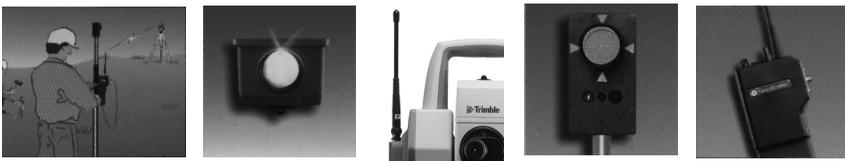
Con un'unità tracker ed un collegamento telemetrico è possibile eseguire rilevamenti robotici. Ciò significa che l'operatore può assumere il controllo di tutta la misurazione da un solo punto, ottenendo quindi un sistema funzionante con un solo operatore. Nelle pagine che seguono descriveremo le diverse tecniche di misurazione possibili con il sistema.
