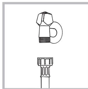
1. Collegare il tubo di alimentazione avvitandolo a un rubinetto d'acqua fredda con bocca filettata da 3/4 gas (vedi figura). Prima di allacciare, far scorrere l'acqua finché non sia limpida.
