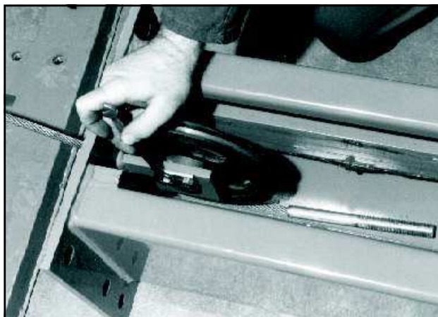
Fig.38 Smontaggio della puleggia Abb.38 Ausbau der Riemenscheibe
