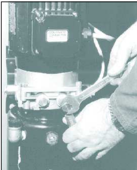
Fig.45 Collegamento idraulico del cilindro Abb.45 Hydraulikanschluss des Zylinders
