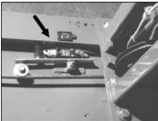
Fig.34 Montaggio del finecorsa Fig.34 Endschaltermontage
