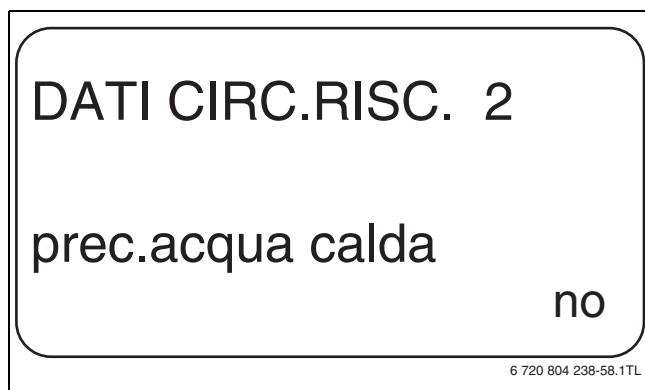
Fig. 56 Impostazione della precedenza acqua calda sanitaria
