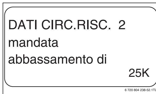
Fig. 50 Impostazione dell'abbassamento per la mandata
