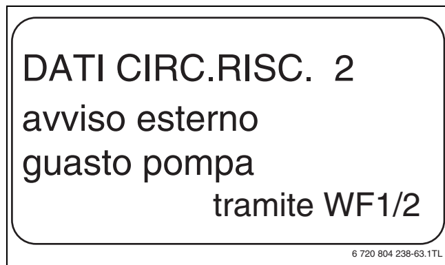
Fig. 61 Avviso esterno disfunzione pompa
