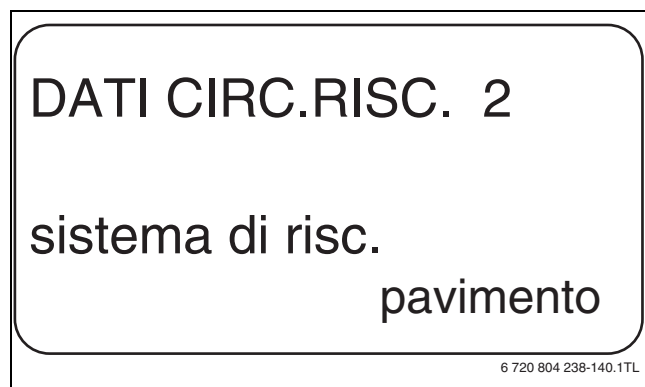
Fig. 38 Scelta sistema di riscaldamento
