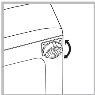
2. Se il pavimento non fosse perfettamente orizzontale, compensare le irregolarità svitando o avvitando i piedini anteriori posteriori (vedi figura); l'angolo di inclinazione, misurato sul piano di lavoro, non deve superare i 2°.
