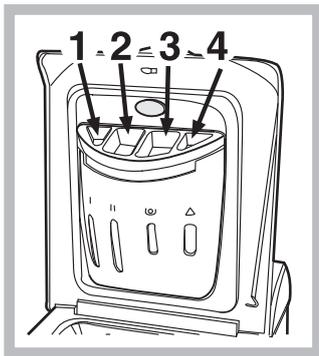
Alzare il coperchio al di sotto del quale è collocato il cassetto dei detersivi e inserire il detersivo o l'additivo come segue.
