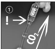
1. CO<sub>2</sub>-Rücklausicherung an den Zuleitungsschlauch der CO<sub>2</sub>-Düngeanlage anschließen. Der rote Glasstäbel ist zur Abdichtung an einer Seite eingeschliffen, erkennbar an dem feinen, weißen Ring. Dieser Ring muss stets zum Druckminderer zeigen! ①
