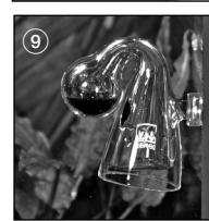
4. Het testreservoir voorzichtig omkeren en met behulp van de zuiger op een goed zichtbare plaats met geringe stroming van het water verticaal in het aquarium bevestigen. ⑨
