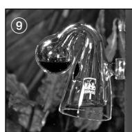
4. Capovolgere con attenzione il contenitore del test e con l'ausilio della ventosa fissarlo nell'acquario in posizione verticale in un posto ben visibile e con un leggero scorciatoio dell'acqua. ⑨
