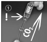
1. Raccordez la protection anti-retour CO<sub>2</sub> au tuyau d'arrivée de l'installation de fumure CO<sub>2</sub>. Le curseur rouge en verre est taillé d'un côté, pour l'étanchéité ; vous le reconnaîtrez au fin cerclage blanc. Ce cerclage doit toujours se trouver du côté détendeur ! ①
