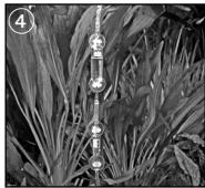
4. De bellenteller en de CO<sub>2</sub>-diffusor met een passend stuk slang verbinden. De bellenteller en het terugslagventiel telkens met 2 zuignappen loodrecht (!) aan de buitenkant van het aquarium bevestigen ④
