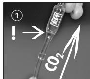
1. Het CO<sub>2</sub>-terugslagventiel op de toevoerslang van de CO<sub>2</sub>-voedingsstofinstallatie aansluiten. De rode glazen stoter is er voor de afdichting aan een zijde ingeslepen; herkenbaar aan de fijne, witachtige ring. D deze ring moet altijd in de richting van de drukregelaar wijzen! ①
