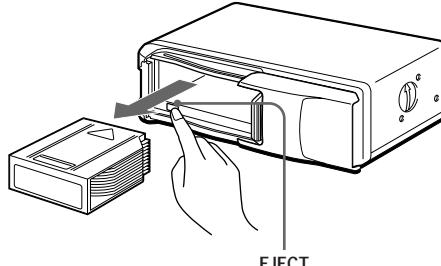
Si vous ne pouvez pas fermer le chargeur de disques. Sortez le chargeur et, après avoir appuyé sur la touche EJECT, réinsérez-le.
