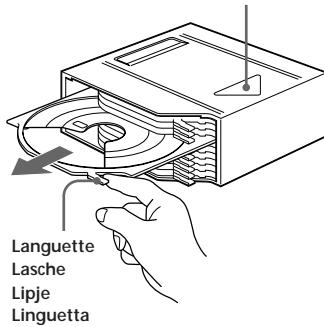
Utilisez le magasin à disques fourni ou un magasin à disques XA-250. Vous ne pouvez pas utiliser de magasin à disques XA-10B avec cet appareil. L'utilisation d'un autre type de magasin à disques risque de provoquer un dysfonctionnement.
