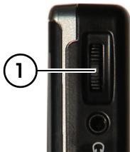
Il comando del volume ① si trova sul lato destro del Traffic Assist.
