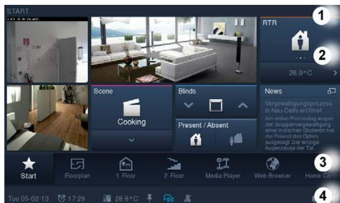
1 Titolo | 2 Area di comando | 3 Barra di navigazione | 4 Barra di stato
