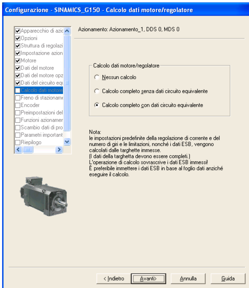
Figura 5-21 Calcolo dei dati del motore/regolatore
